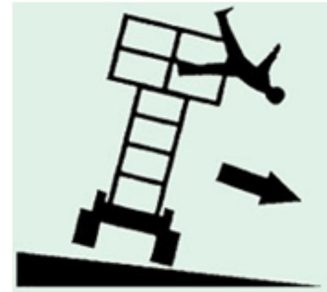
Vuelco del equipo por falta de estabilidad
