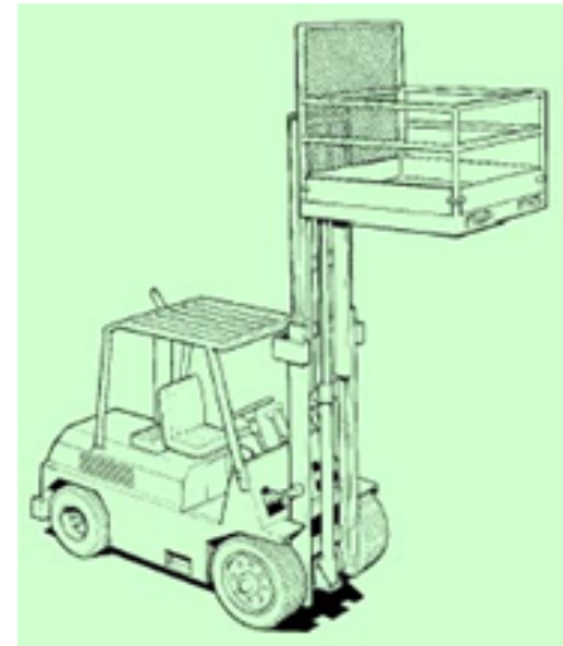
Canasta elevada por montacargas
