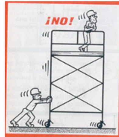
Movimiento incorrecto de un andamio
