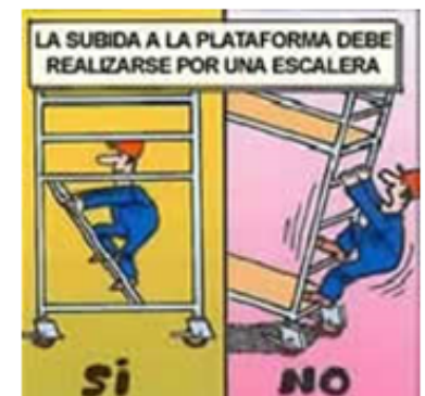
Acceso a un andamio
